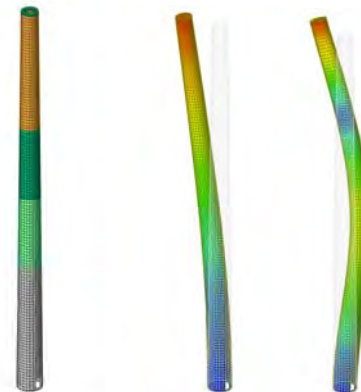
Modello FEM 1° e 2° modo di vibrare I colori diversi evidenziano i diversi spessori della struttura
